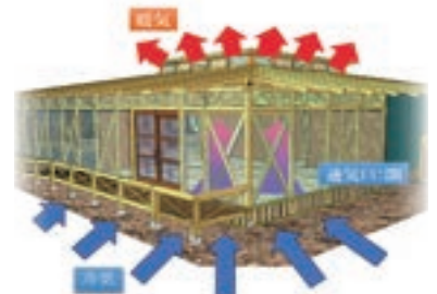
床のかさ上げと空調システム
