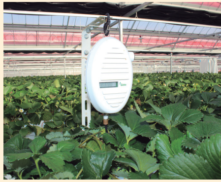
CO 2 濃度などを監視する、専用センサボックス
