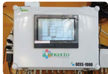
「コンチェルト」が司令塔となりハウス内環境を制御する
